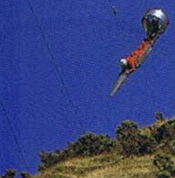
に腹ばいになつて乗り込む。後部には航空機用エンジンとプロペラが装備されており、目の前のハンドルとアクセルで操縦するのだ。最高速度は170キロにもおよぶ、これは自分で運転できるアミューズメントものとしては世界最
